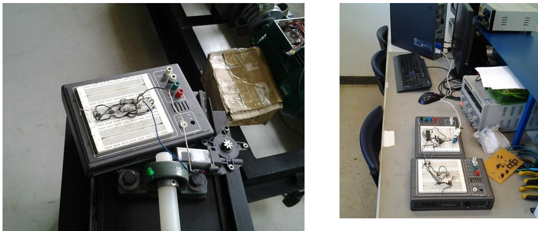
Figura 7. Sistema eletrônico em protoboards : (1) acionando o “motor de carregamento” e (b) ligações às portas de um computador pessoal.
