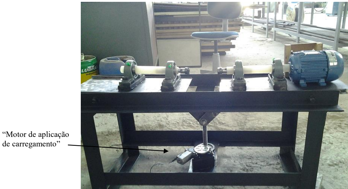
Figura 6. Montagem geral do protótipo da máquina de ensaio.
