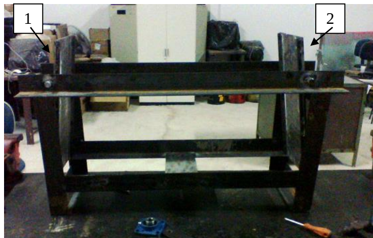
Figura 5. Mesas articuladas (1) e (2) e base da máquina de ensaio.
