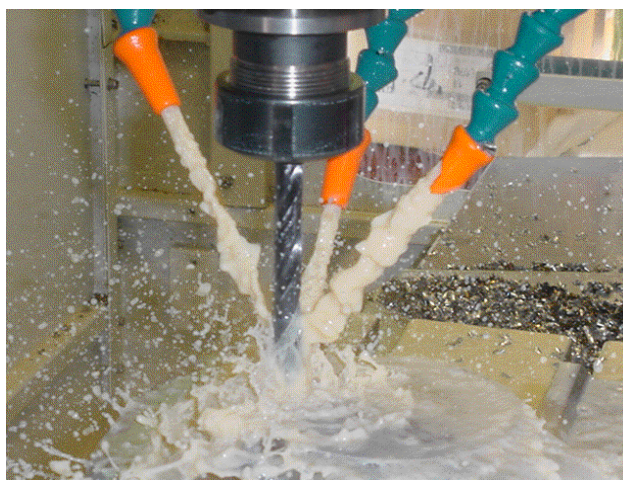
Figura 2. Aplicação por jorro do fluido de corte semi-sintético, vazão total de 1230 L/h (Costa, 2004).
