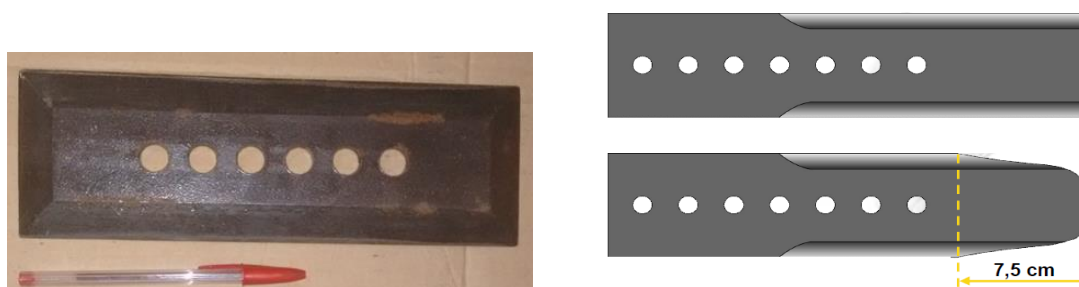
Figura 4 – (a) Faca Corte de Base, (b) Desgaste faca corte de base.
