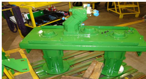
Figura 2 – Caixa do corte de base montada.
