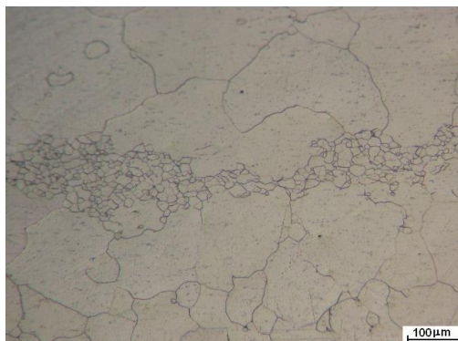
Figura 5 – Micrografia da amostra submetida a 710°C por 120 minutos
