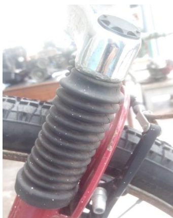
Figura 5. Suspensão utilizada no protótipo
