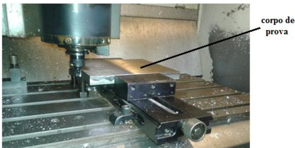
Figura 6 - Esquema de fixação do corpo de prova na máquina
