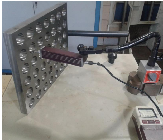
Figura 8 - Medição da rugosidade ( R_a ) das condições de usinagem utilizadas
