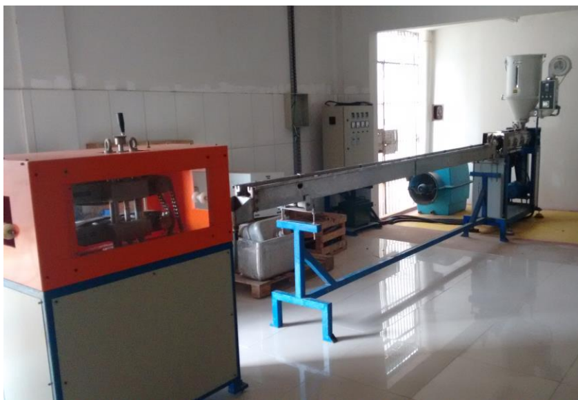
Figura 11. Unidade de Extrusão em fase de montagem no Departamento de Mecânica e Materiais – DMM do IFMA (Fonte: Autor).
