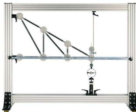
Figura 2. Bancada de Deformação de Treliças SE110.44 (GUNT, 2016)
