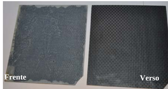
Figura 3. Materiais compósitos processados com véu de fibra de vidro absorvedor de radiação (frente) e com fibra de carbono (verso).
