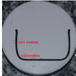
Figura 5. Posições da medida da espessura (Autoria própria).
