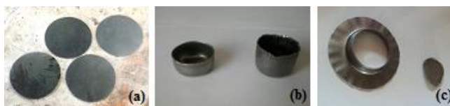
Figura 2. Corpo de prova. (a) Antes do ensaio Swift; (b) Após o ensaio Swift; (c) Com ruptura (Autoria própria).
