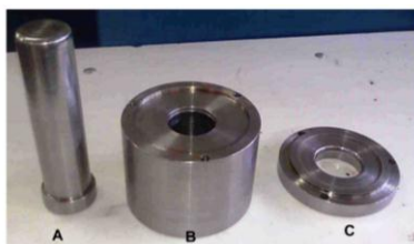
Figura 3. (A) Punção, (B) prensa-chapas e (C) matriz (Autoria própria).
