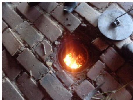
Figura 06: Chama vertical na entrada de uma boca de alimentação de forno Hoffman.
