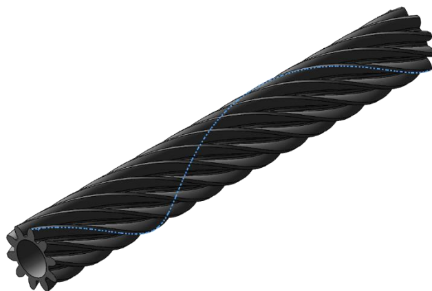
Figura 4. Eixo com dentes helicoidais para ilustração da hélice (helicóide ou espiral) formada por um dente em uma engrenagem helicoidal direita
