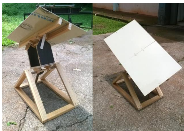
Figura 4: Maquete (modelo icônico tridimensional) do direcionador automático de célula fotovoltaica.
