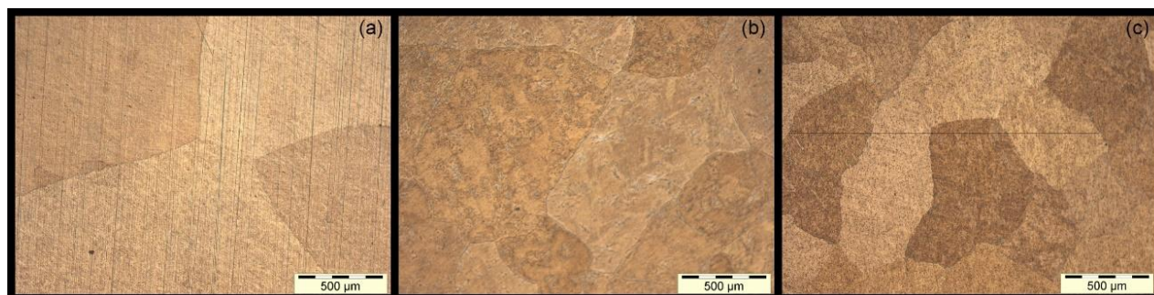
Figura 2. Micrografia dos lingotes de Cu-Al-Be com adição de Titânio homogeneizados: (a) 0%, (b) 0,5% e (c) 1% (%em peso).
