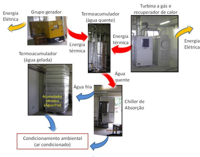
Figura 1. Esquema do sistema de microcogeração em escala laboratorial do DEMEC-UFPE.
