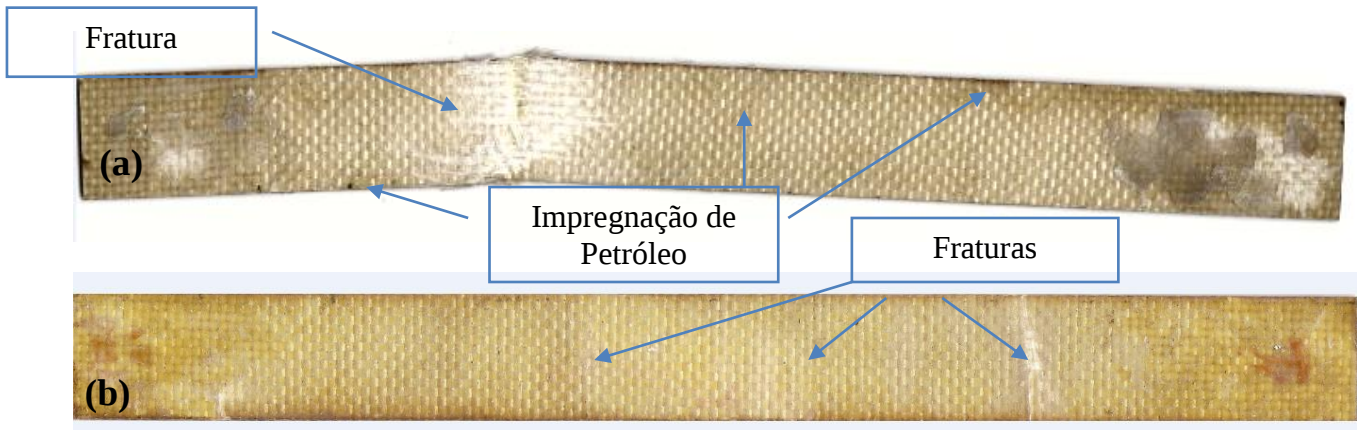
Figura 5. Fratura do compósito fibra de vidro/kevlar após ensaio de tração uniaxial no estado de envelhecimento: (a) Petróleo e (b) água do mar.
