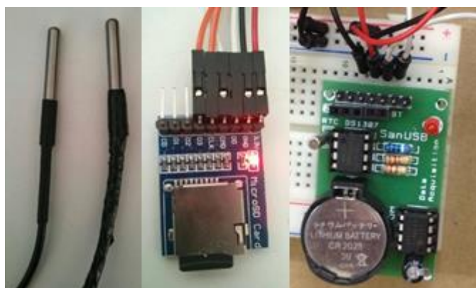
Figura 2. Da esquerda para direita: sensores de temperatura DS18B20, módulo SD e módulo RTC. Fonte: próprio autor.
