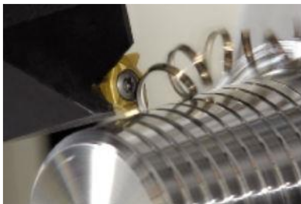
Figura 2. Torneamento de rosca (SANDVIK, 2010)
