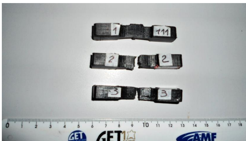
Figura 7. Corpos de prova em PEAD: (1) virgem, (2) com cordão de solda após ensaio de tração (3) sem cordão de solda após ensaio de tração.
