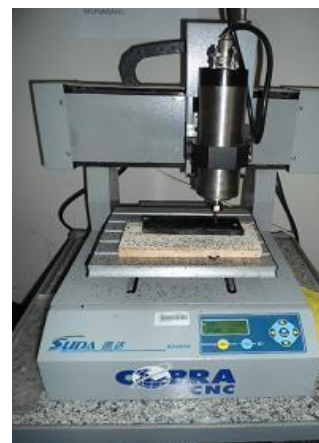
Figura 2. Usinagem das amostras com fresadora CNC.
