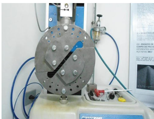
Figura 4. Corpo de Prova no dispositivo de Arcan fixado em máquina de tração Tensolan Mesdlan para ensaio de tração em um ângulo de 45 graus.
