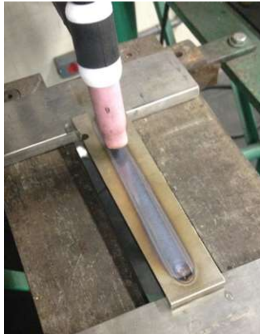
Figura 2: Exemplo do cordão de solda sobre chapa de aço inoxidável austenítico AISI 304L.
