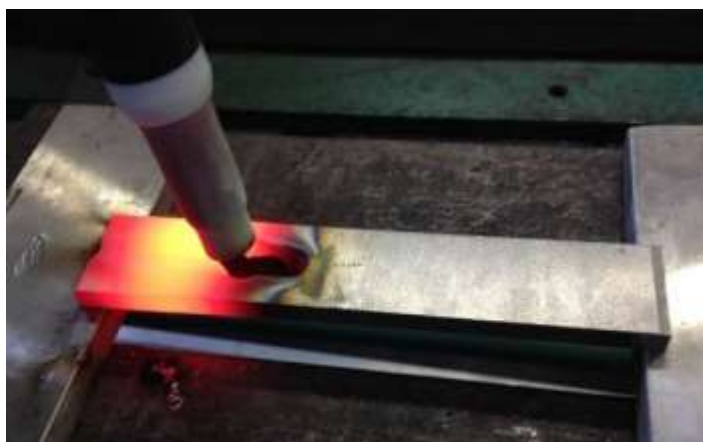
Figura 4: Poça de fusão muito larga, pingando e gerando um buraco na chapa.
