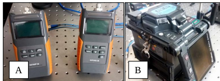
Figura 3. Power meter GFHP-B (A), máquina de fusão FSM-60S (B), utilizados para fabricação dos sensores.
