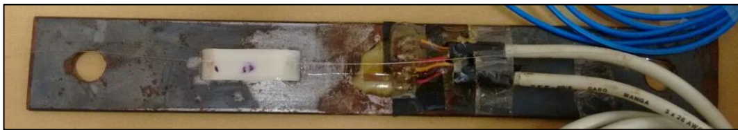
Figura 4. Barra de aço SAE 1020 instrumentada com os SGs e FOs.
