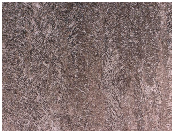
Figura 07 - Martensita gerada na ZF da Peça 04. Zoom de 100x
