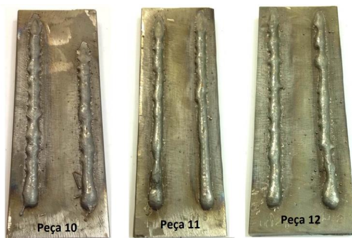
Figura 05 – Cordões de Solda da Parte B, com Aço Inox na Frente do Aço Carbono
