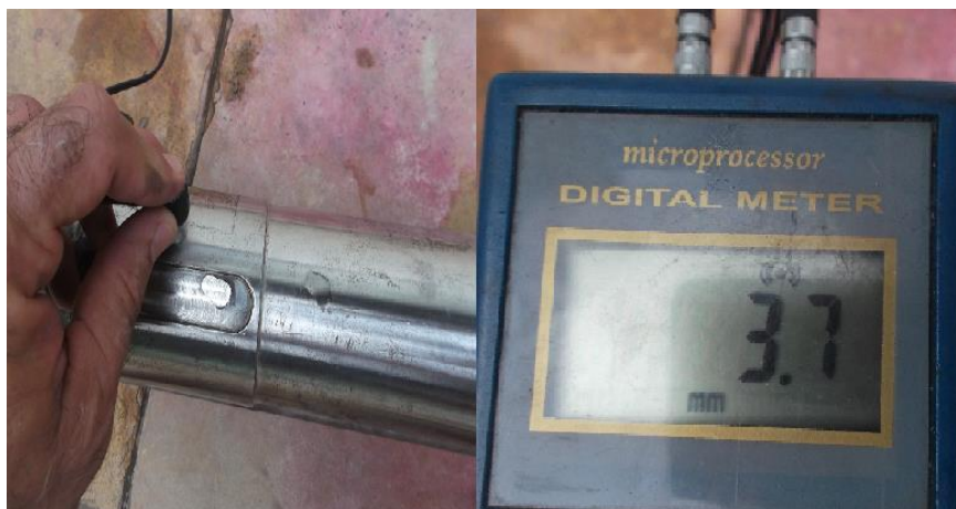
Figura 5. Medida do Eixo Através do Teste de Ultrassom
