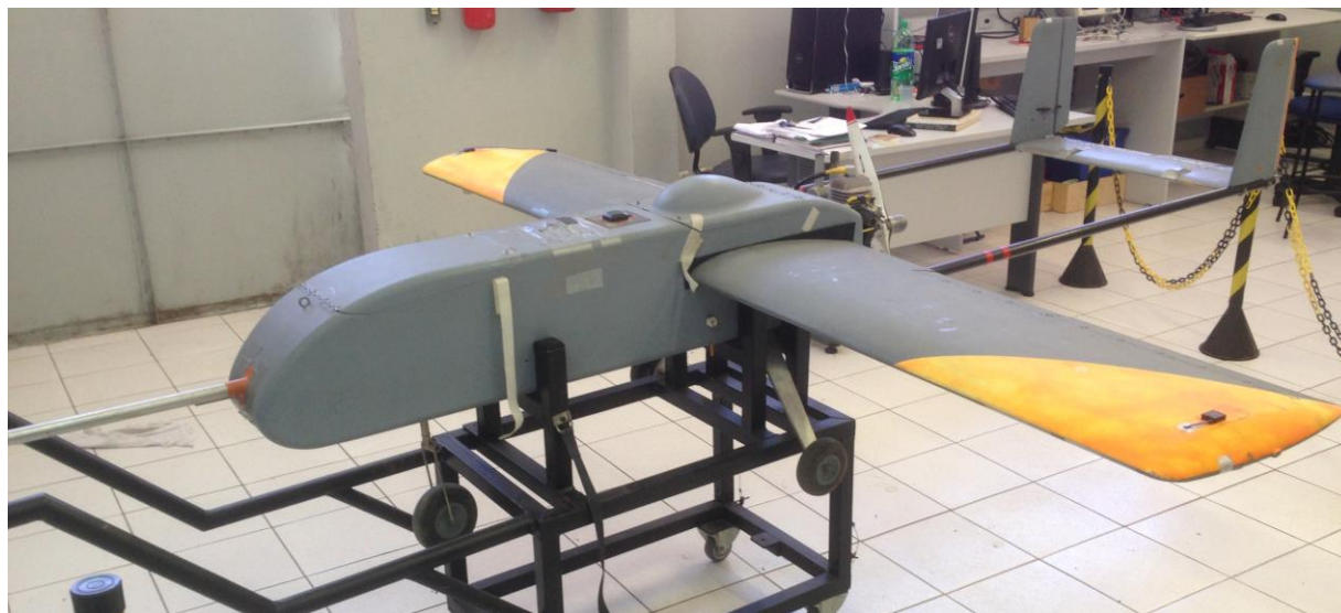
Figura 3. VECTRO-P, VANT pertencente ao laboratório de sistemas aeroespaciais do Instituto Tecnológico de Aeronáutica.
