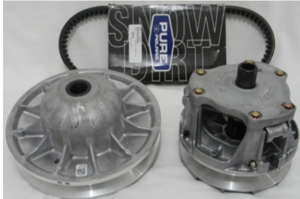
Figura 2. Modelo do comando da transmissão continuamente variável Fonte: Polaris P90
