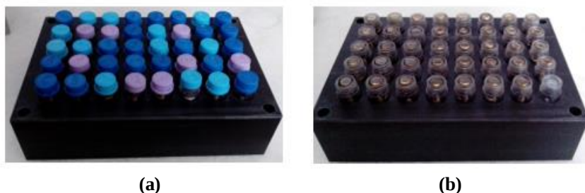
Figura 6. Base superior do dispositivo. (a) base superior com os frascos externos montados com as tampas externas; (b) base superior com os frascos externos montados com os frascos internos – Fonte: SISTEMA INP (dados internos).
