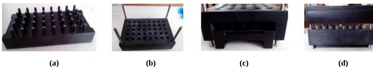
Figura 5. Dispositivo para Montagem de Frascos. (a) base com pinos; (b) base inferior; (c) montagem da base com pinos e base inferior; (d) montagem do conjunto do dispositivo com a base superior. – Fonte: SISTEMA INP (dados internos).
