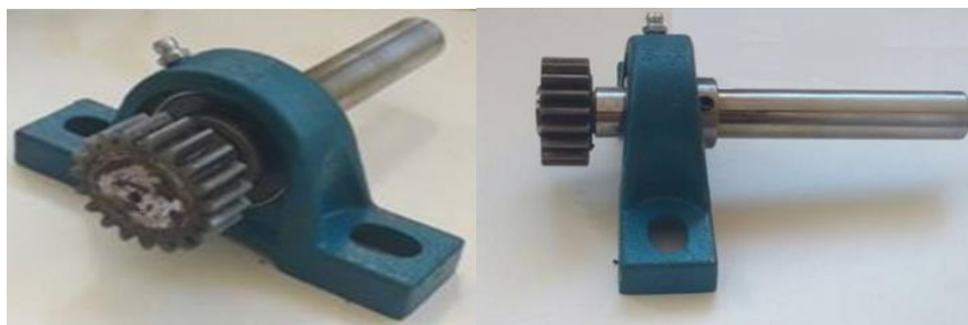
Figura 7 – Eixo secundário preso a mancais com rolamento com a segunda engrenagem em uma das extremidades. Fonte: Próprio autor, 2016
