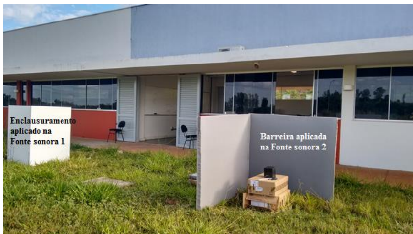
Figura 11. Foto dos tratamentos acústicos aplicados.
