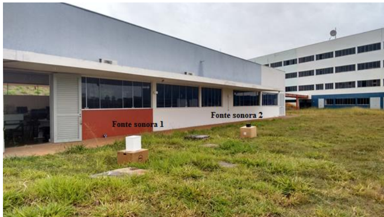
Figura 3. Foto da região analisada com as fontes sonoras posicionadas.
