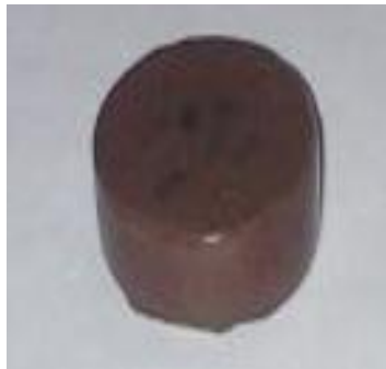
Figura 7. Corpo de prova utilizado no ensaio de microdureza Vickers.
