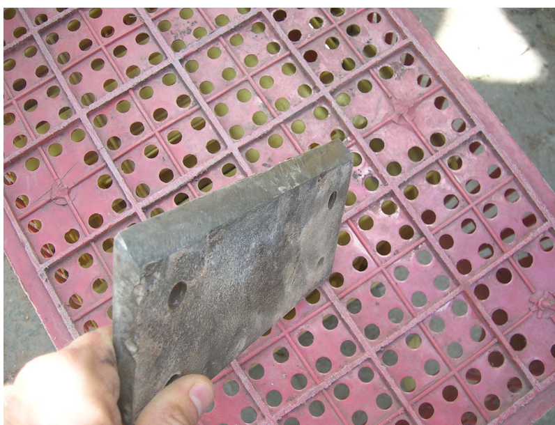
Figura 6. Faca/batedor fixado ao quebrador de coco. (Fonte: Leite, Santiago 2015).
