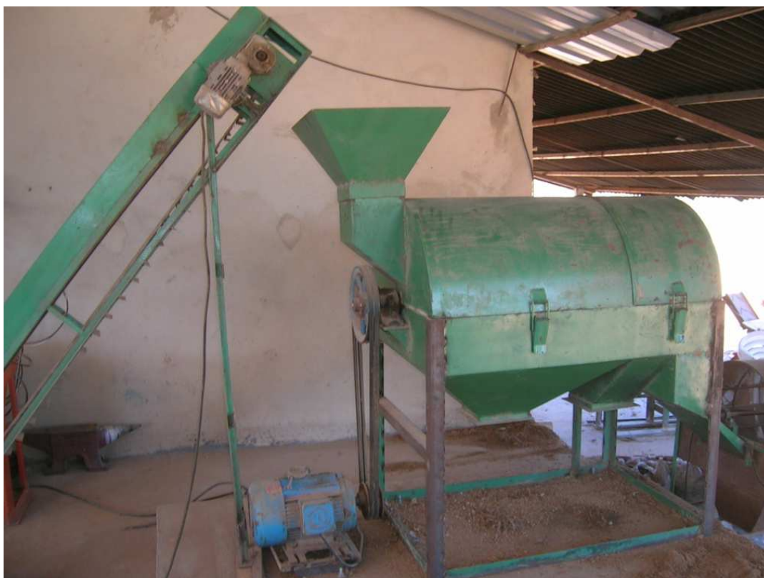
Figura 2. Máquina de beneficiamento do coco babaçu produzida pela Babaçubras Indústria e Comércio Ltda, em Teresina (PI). (Fonte: Leite, Santiago, 2015).
