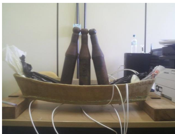
Figura 4. Barco durante o ensaio e totalmente carregado.
