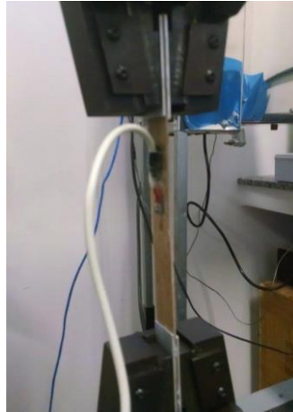
Figura 4. Ensaio de tração do corpo de prova
