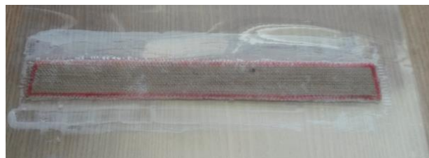
Figura 3. Corpo de prova pronto para prensagem e cura
