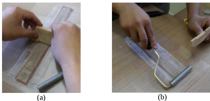
Figura 2. Fabricação do compósito: (a) distribuição de resina sobre o tecido; e (b) homogeneização da resina com o rolo tira bolhas.
