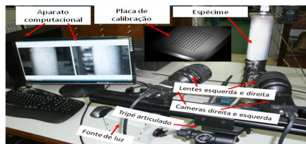
Figura 5. Componentes básicos utilizados nas medições com a técnica DIC.
