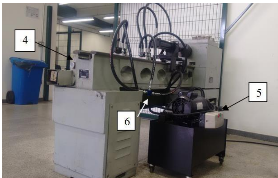
4 = Torno Convencional 5 = Central Hidráulica 6 = Conexão T
