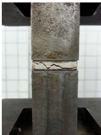
Figura 11. Fratura em corpo de prova revestido de fibra de vidro.
