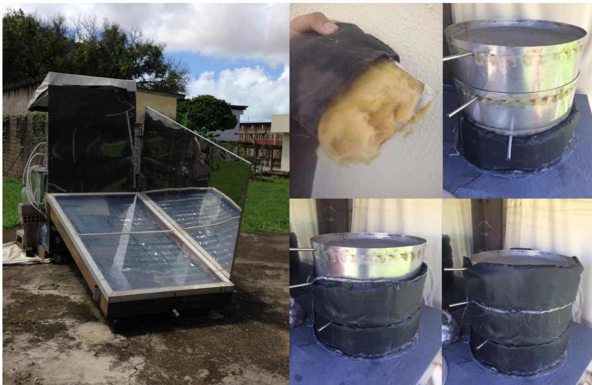
Figura 5. As fotos mostram o sistema montado com refletor, com 1,2 ou 3 isolamentos. A foto do canto superior central mostra como a lã está inserida no tecido. Fonte: próprio autor.
