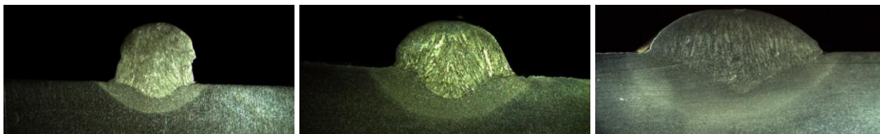
Figura 2: Imagens macrográficas obtidas, com aproximação de 6,3 vezes, para a soldagem por curto-circuito (a), soldagem globular (b) e soldagem por aerossol (c).
