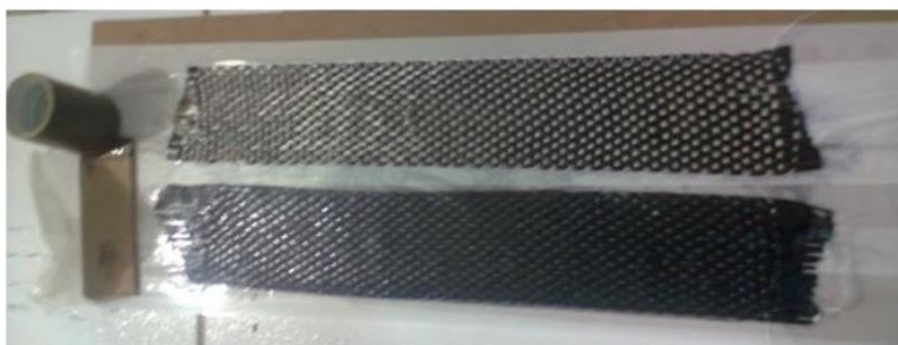
Figura 5. Fibra de carbono com orientação unidirecional longitudinal (0°) durante o processo de impregnação da resina epóxi no processo de fabricação hand lay-up .
