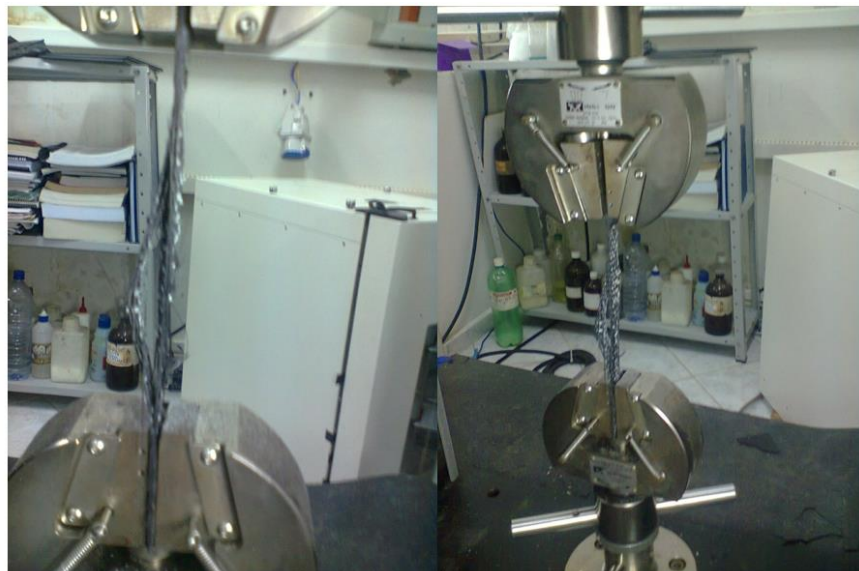
Figura 8. Instante da ruptura do corpo de prova 1 (CP1).
