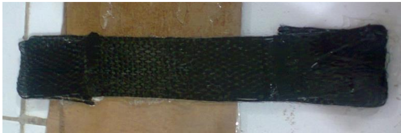
Figura 6. Confecção de corpo de prova: fibra de carbono/epóxi com extremidades dobradas para a simulação dos tabs .
