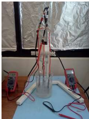
Figura 1: Célula de processamento utilizada na obtenção do revestimento.
