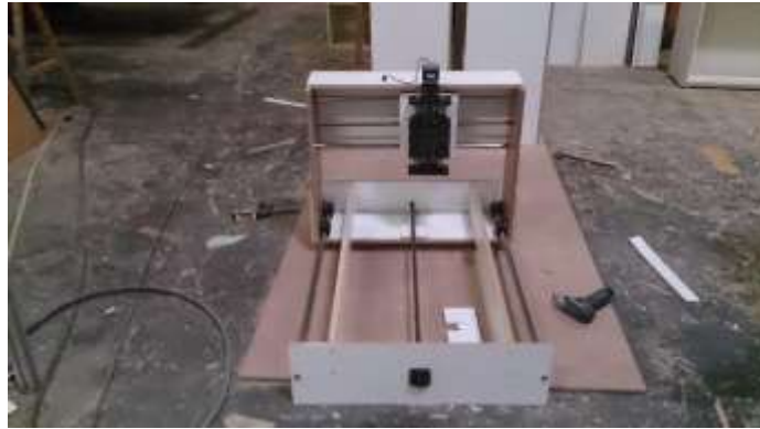
Figura 1. Imagem do chassi do protótipo em construção.
