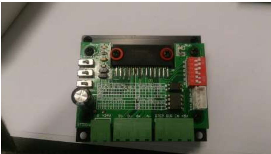
Figura 3. Driver baseado no circuito integrado TB6560
