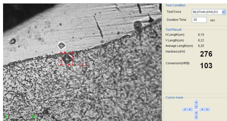
Figura 12. Micro estrutura do aço AISI H13 usinado com fluido (óleo mineral). Attack: Nital 2%
