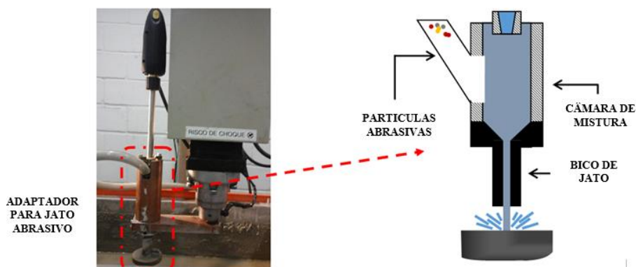
Figura 2. Bico Venturi na adaptação para AJEDM (fonte próprio autor)
