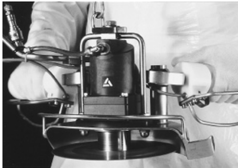
(a) Serra para processamento de carne (Hitchcox, 2012).
