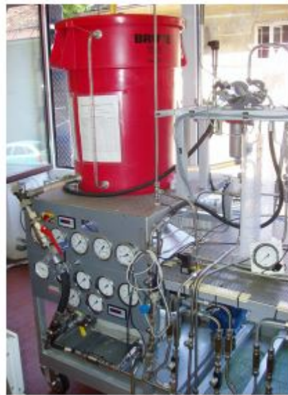
Figura 2: Equipamento de testes da Universidade de Ljubljana (Majdič e Pezdirnik, 2008).
