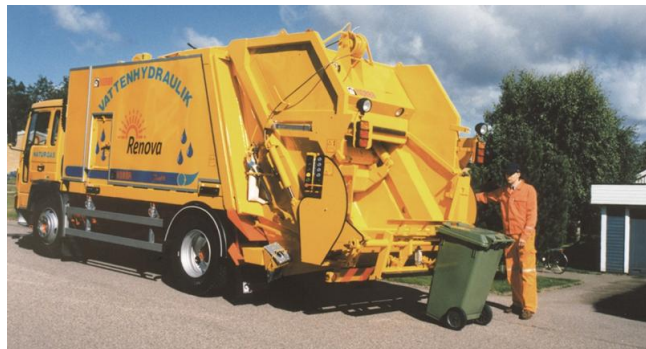
(b) coleta de lixo com acionamentos hidráulicos à água (Hitchcox, 2012).
