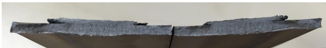
Figura 9. Superfície após Ruptura da Amostra para Avaliação da Aderência
