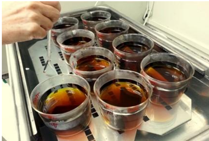
Figura 4. Soluções com as amostras no momento da imersão na banheira termostática a 50^{\circ}\text{C} \pm 2^{\circ}\text{C} .
