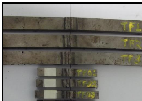
Figura 1- Material para confecção de corpos de prova após corte em serra de fita.
