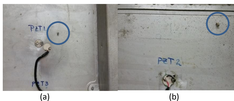
Figura 3 – Pannel de alumínio com adição de massas simulando os danos.
