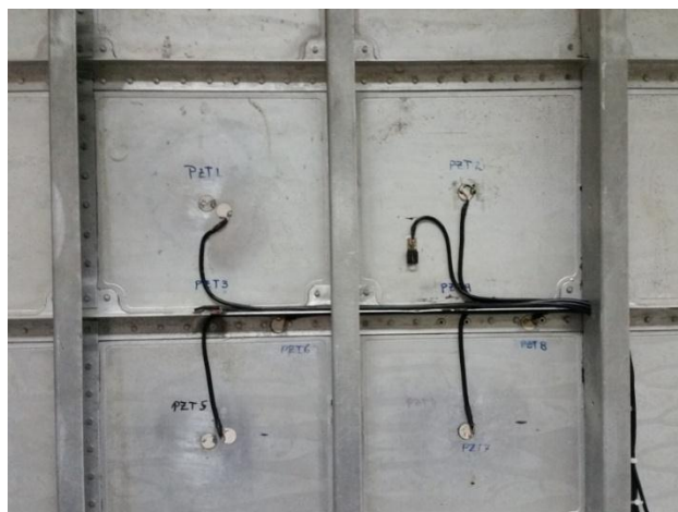
Figura 2 – Pannel de alumínio, com 4 PZTs, usado no painel
