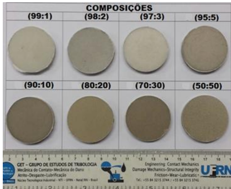
Figura 3. Composições dos compósitos de PTFE e Rejeito de Scheelita.
