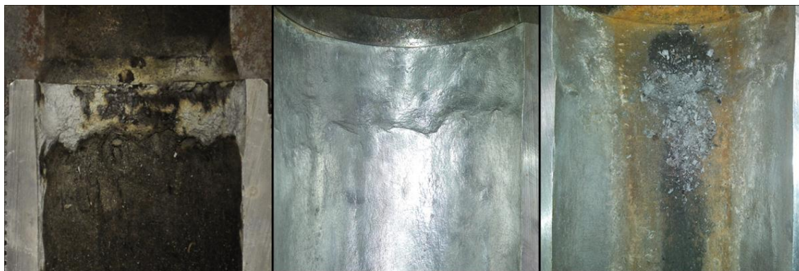
Figura 126. Fotografia da tubulação antes do experimento, durante e após o término dos testes.
