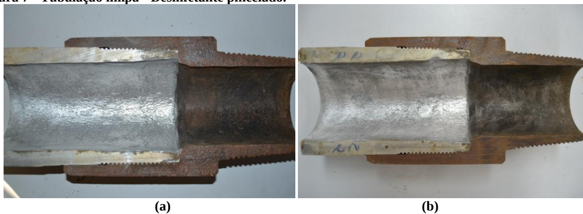
Figura 19. Fotografia da tubulação limpa com aplicação do desinfetante: (a) pincelado e (b) depositado.
