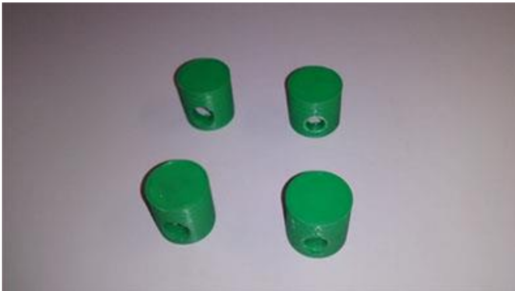
Figura 3 – Pistões Impressos em PLA.
