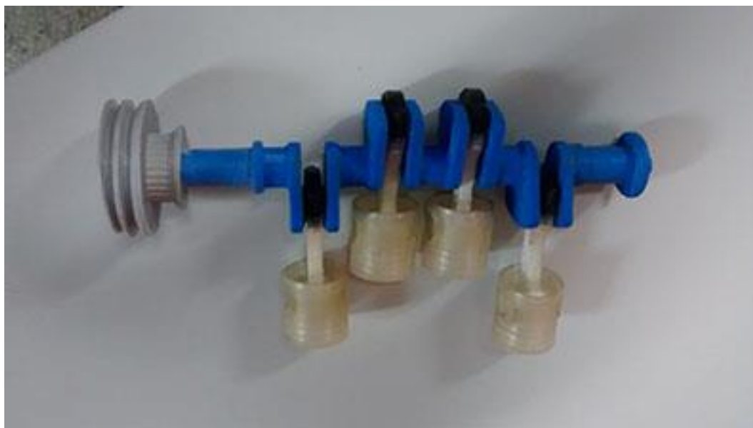
Figura 4 – Conjunto Virabrequim, bielas e pistões impresso em PLA.
