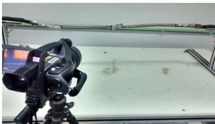
Figura 4. Posicionamento do termovisor para avaliação dos conectores.
